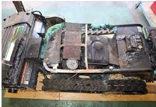
写真4 焼損したラジコン草刈機
