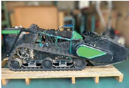
写真2 焼損したラジコン草刈機
