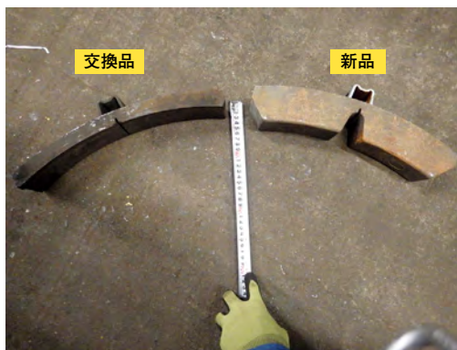
写真9 制輪子の比較状況
