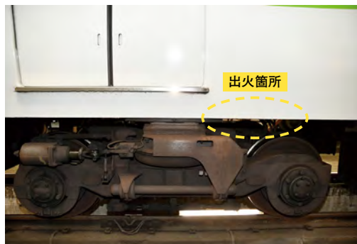
写真4 出火箇所付近の状況
