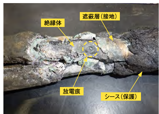
写真9 高圧ケーブルの放電痕
