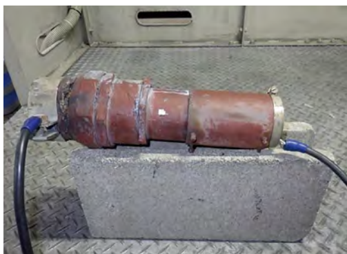
写真10 低圧短絡試験装置による通電試験
