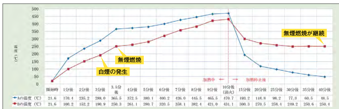
加熱による鉄粉内部の温度変化
