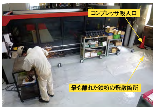
火災当日のグラインダ作業再現状況
