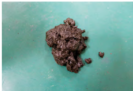
コンプレッサ内の残渣物
