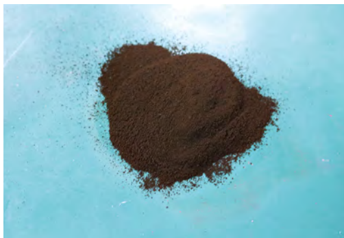
集塵機に堆積する鉄粉
