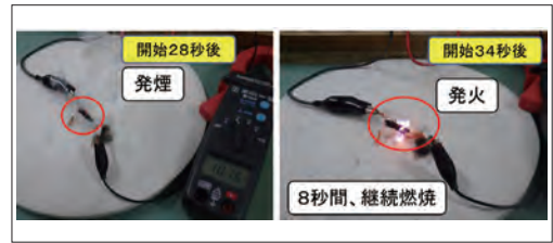
写真13 半断線による燃焼実験の状況
