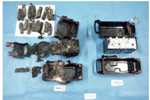
写真4 電動アシスト付自転車用バッテリーの焼損状況
