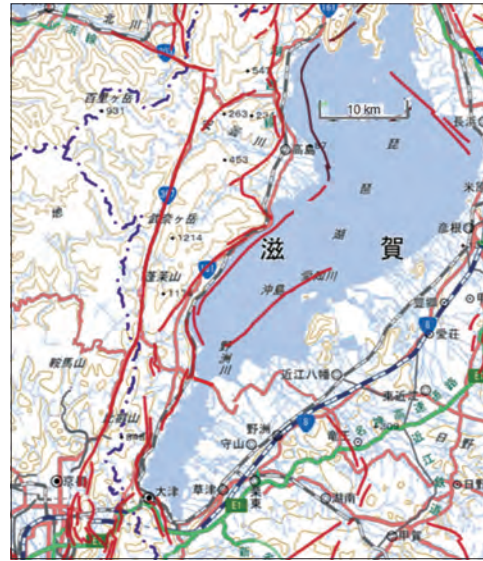
水平右ずれの花折断層と逆断層の琵琶湖西岸断層帯 (出典:産総研データベース)
