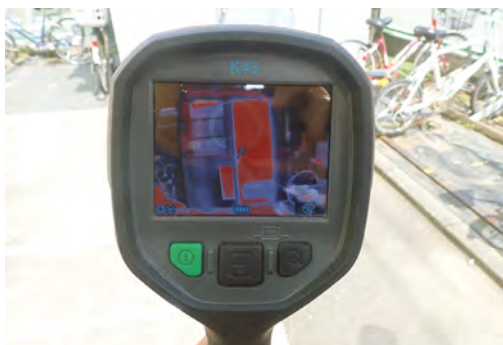
写真9 熱画像直視装置による温度測定状況
