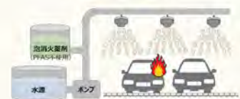
【駐車場の泡消火設備のイメージ】
