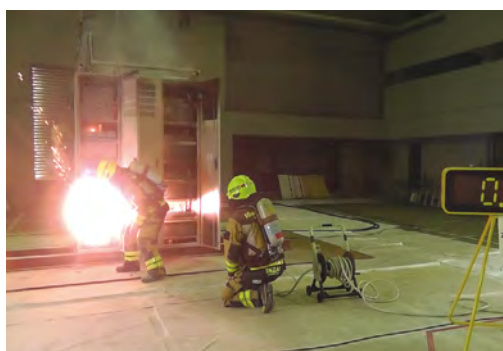
消火中のスパーク状況
