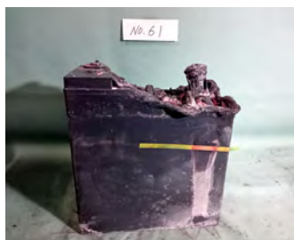
バッテリーの焼損・液漏れ状況
