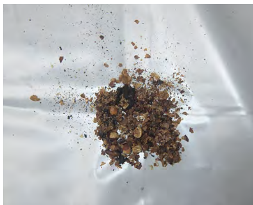
シリンダー内に堆積していた珈琲豆のくず
