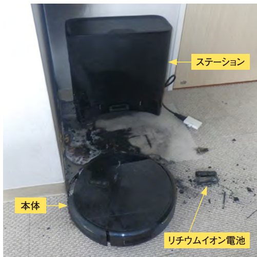
写真 1 焼損状況の全景
