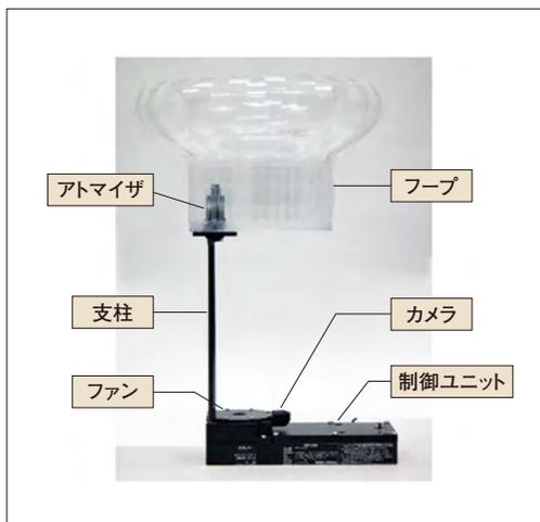
図2 ドローン搭載用加煙試験器構成図
