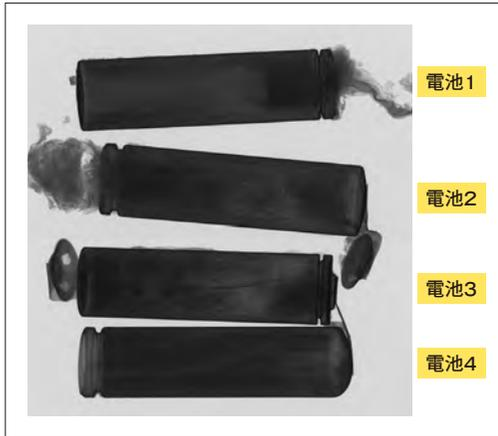
写真3 リチウムイオン電池をX線撮影
