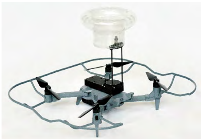
写真1 ドローンおよびドローン搭載用加煙試験器
