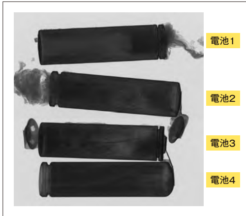
写真3 リチウムイオン電池をX線撮影
