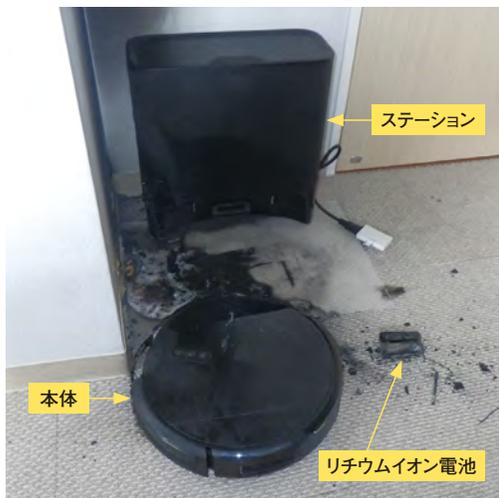
写真 1 焼損状況の全景
