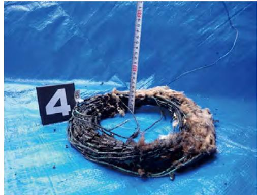
写真5 焼損した束状のPVケーブル
