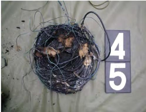
写真3 焼損した束状のPVケーブル
