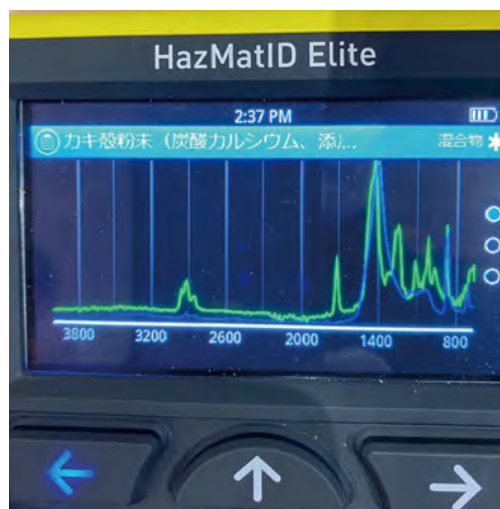
写真6 フーリエ変換赤外分光装置の測定スペクトル
