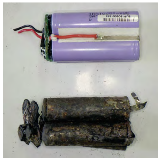
写真1 焼損したバッテリーと同型品
