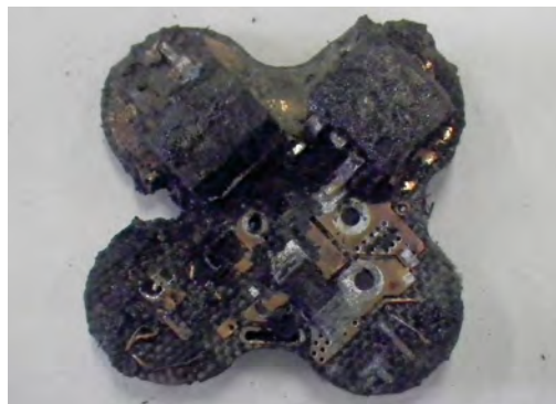
写真4 基板の欠損状況
