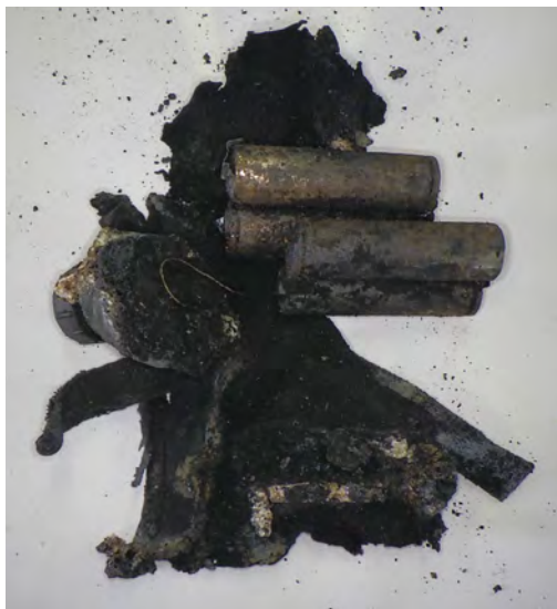
写真3 焼きしたリチウムイオン電池
