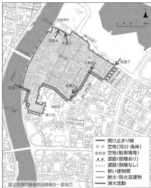
図2 輪島市大規模火災の焼け止まり要因 2) と写真の撮影位置
