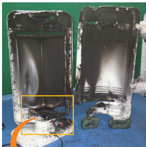
写真3 カarbonヒーター左下部焼損状況
