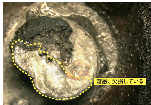
写真14 ダイオード素子表面の溶融状況
