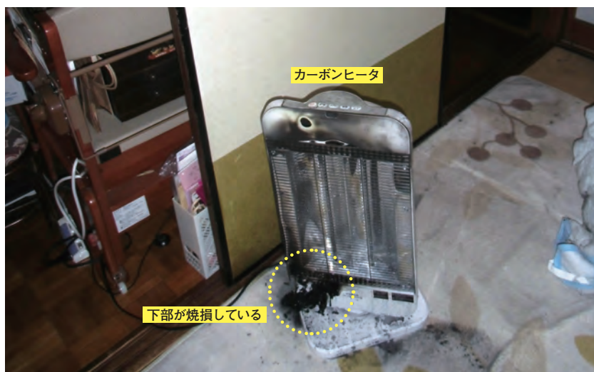
写真1 カarbonヒータの焼損状況
