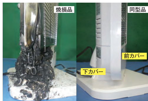
写真3 カarbonヒーター左下部焼損状況
