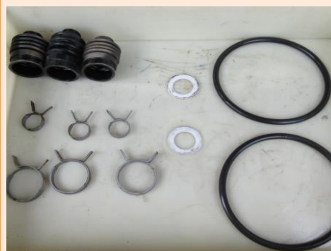
⑦ 燃料、冷却水、潤滑油、給気、排気系統や外箱等に用いられるシール材
