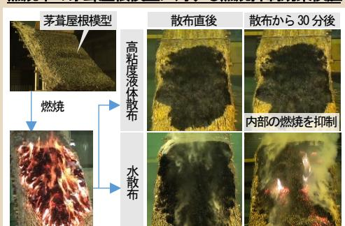
本製品「高粘度液体放射装置 PROTECT GEL(可搬式・設置式)」は、文化財等の伝統的構造物や木造住宅密集地域に見られる木造建築物の外壁や茅葺屋根などの植物性屋根の火災に対し、高粘度液体(薬剤)を放射することにより着火遅延効果や燃焼抑制効果を発揮する初期消火活動の支援機材であり、次に掲げる特長、構造、機能を有するものである。
