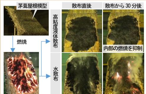
本製品「高粘度液体放射装置 PROTECTGEL(手持ち式)」は、文化財等の伝統的構造物や木造住宅密集地域に見られる木造建築物の外壁や茅葺屋根などの植物性屋根の火災に対し、高粘度液体(薬剤)を放射することにより着火遅延効果や燃焼抑制効果を発揮する初期消火活動の支援機材であり、次に掲げる特長、構造、機能を有するものである。
