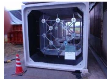
図26 枠状構造物の設置状態図
