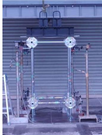
図27 枠状構造物の耐荷試験状況
