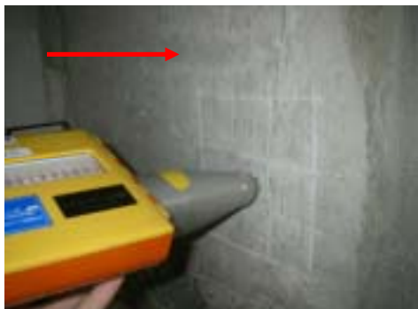
写真－３ 水平方向の打撃例
