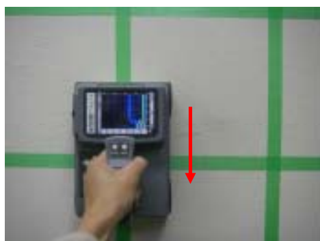
写真－7 鉛直方向の走査例
