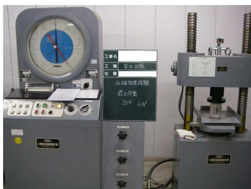
図-4.13 コンクリートコア圧縮強度試験の事例
