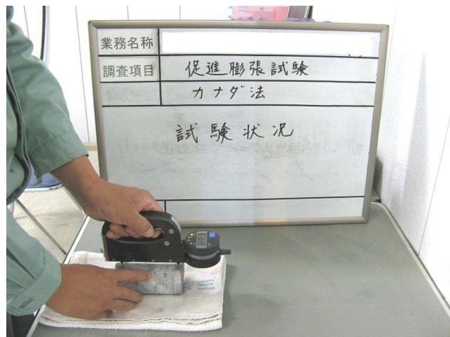
図-4.17 コンクリートコアの膨張量測定事例
