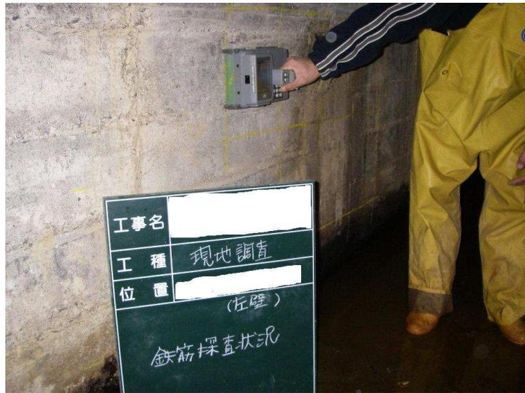
図-4.7 鉄筋探査(電磁波レーダー)状況の事例
