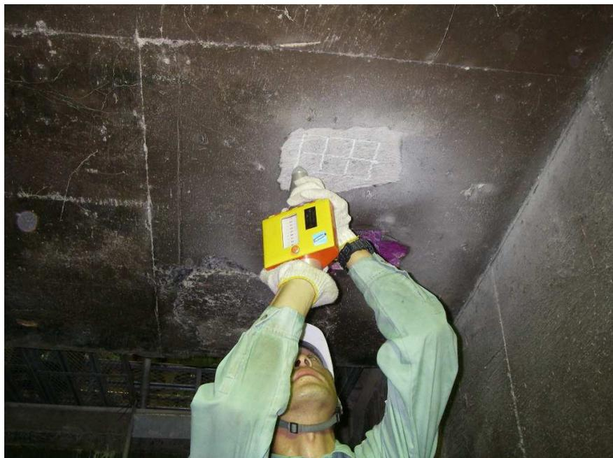
図-4.11 反発硬度測定状況
