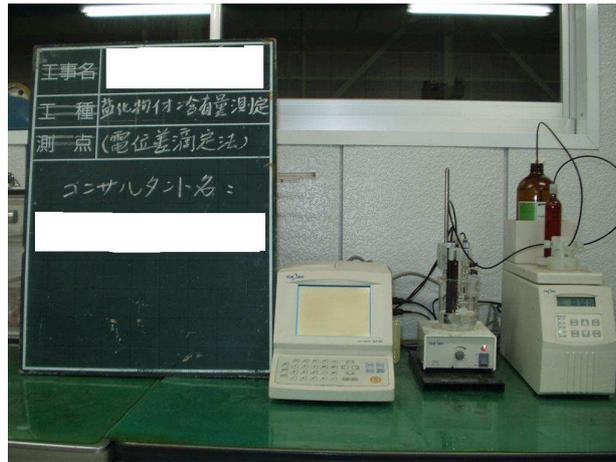
図-4.17 コンクリートの塩化物イオン濃度測定事例
