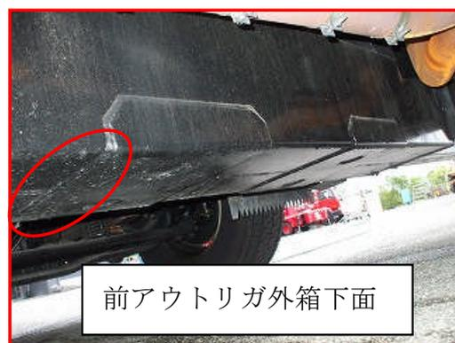
3. 車両前方に進み、前アウトリガ外箱下面を点検する。
