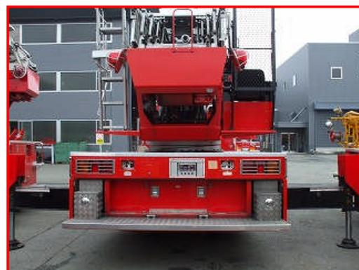
2. PTO OFF、エンジン停止後、車両後方より車両下にもぐり込みアウトリガ後外箱下面を点検する。
