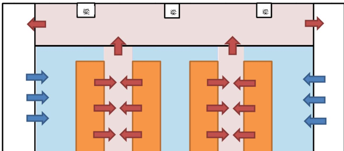
空調機からの冷気が（コールドアイル⇒サーバー⇒ホットアイル⇒天井裏⇒空調機）の流れで循環していく。比較的小規模なサーバールームに多い方式。
