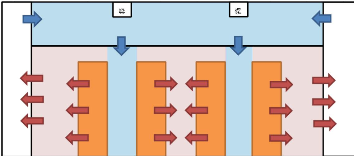
空調機からの冷気が（天井裏⇒コールドアイル⇒サーバー⇒ホットアイル⇒空調機）の流れで循環していく。
