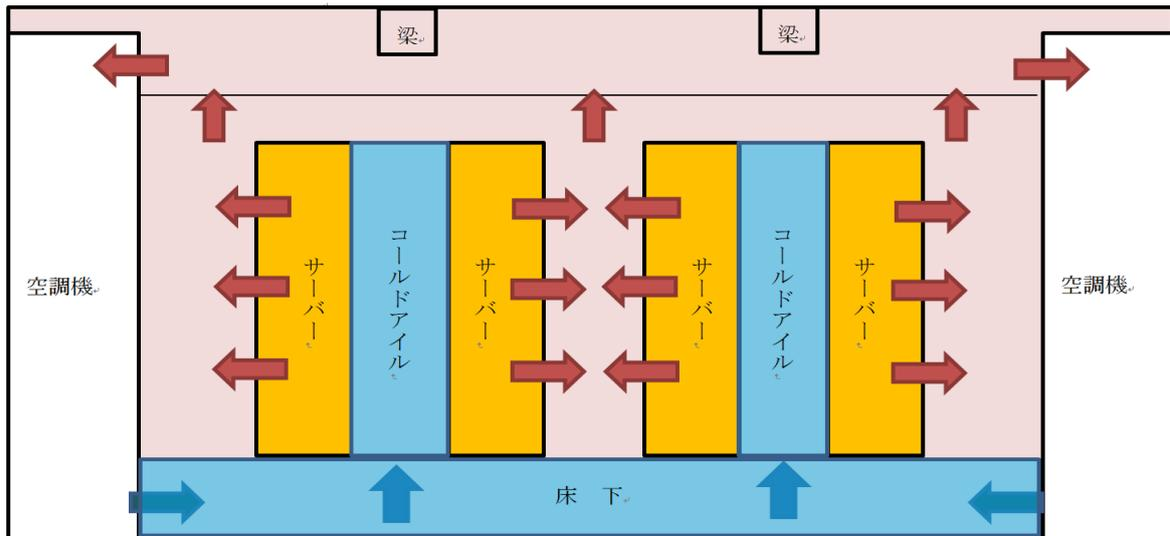
空調機からの冷気が（床下⇒コールドアイル⇒サーバー⇒ホットアイル⇒天井裏⇒空調機）の流れで循環していく。
