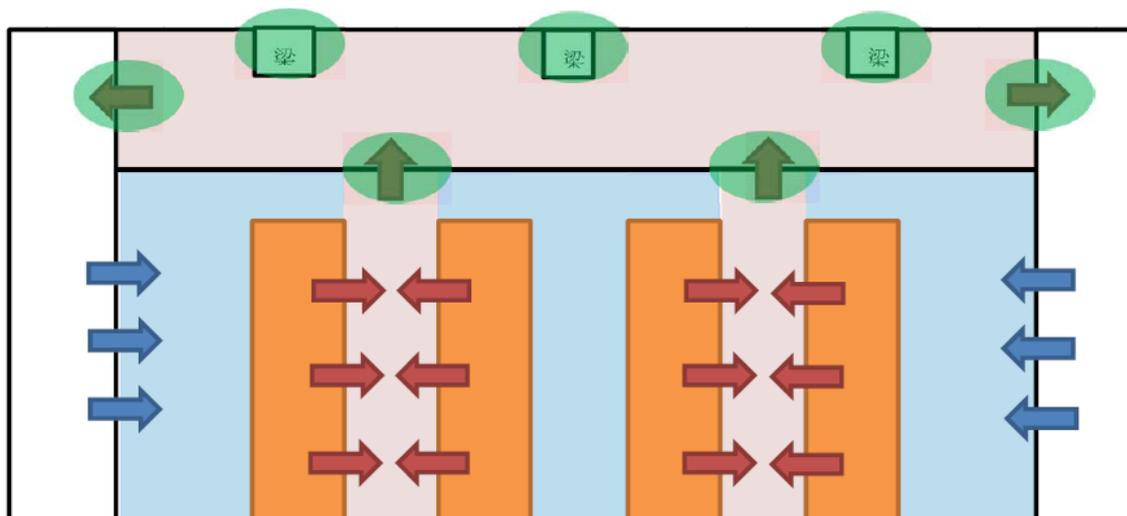
図に緑のマーキングで示す通り、ほぼ例外なく気流の澁みが発生する「天井裏の梁付近」に、また、必ず空気の流れがある場所として空調の吸い込み口、吹き出し口付近に設置されている。
