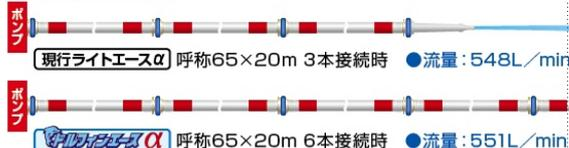
本製品「ドルフィン」は、消火活動に使用する消防用ホースで、ホースの内張りを平滑化し、放水時の圧力損失を自社従来品に比べて50%低減させたもので、次に掲げる特長、構造・機能を有するものである。
